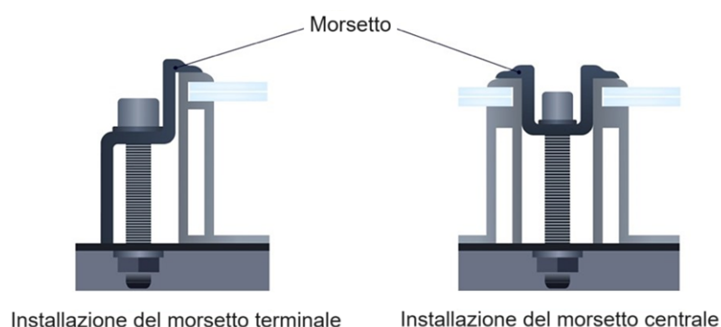
Figura 25: Esempio di installazione con morsetto.
