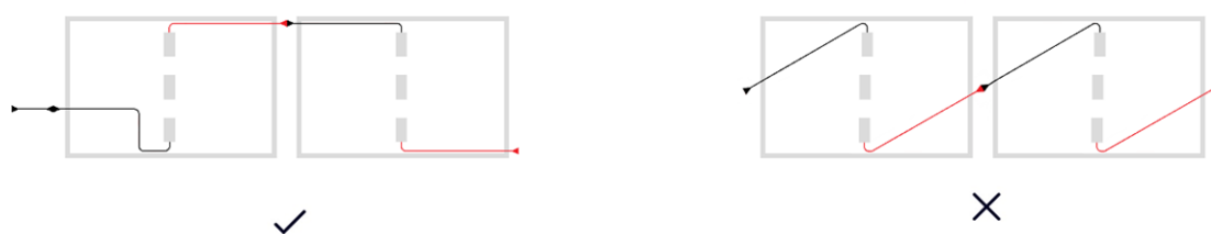
Figure 31 Daisy-Chain posizionamento e interconnessione per moduli orizzontali.
