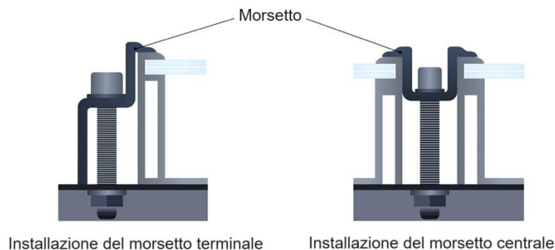
Figura 25: Esempio di installazione con morsetto.
